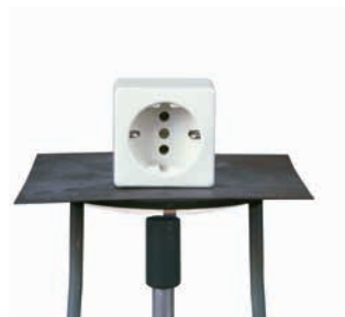
Duroplaste bleiben bei diesen Temperaturen unverändert.
