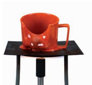
Thermoplaste schmelzen beim Erhitzen.
